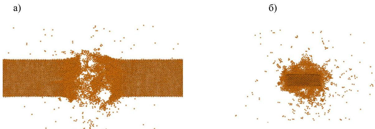
*Рис.2. Разрыв медного нанопровода в результате бомбардировки атомом Ar с начальной энергией 20 кэВ. а) вид в плоскости (x,y), б) (x,z).*
